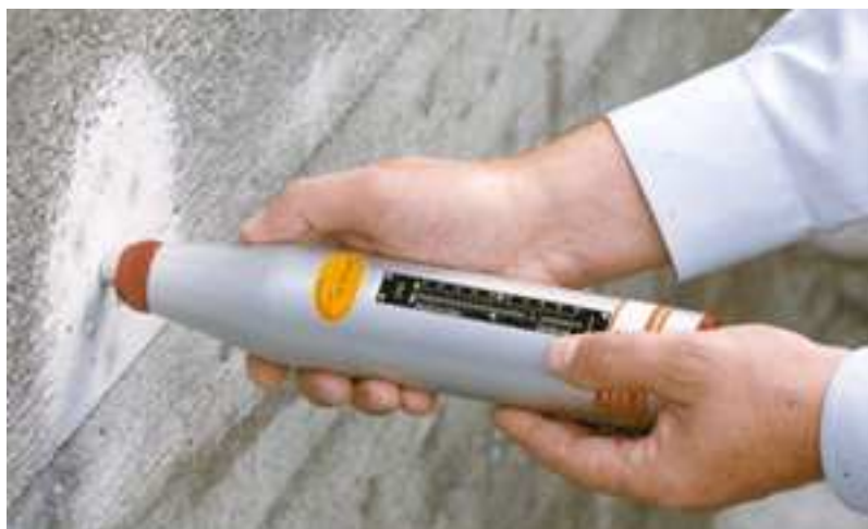
Obr. Použitie Schmidtovho tvrdomera na vybrúsenom mieste
