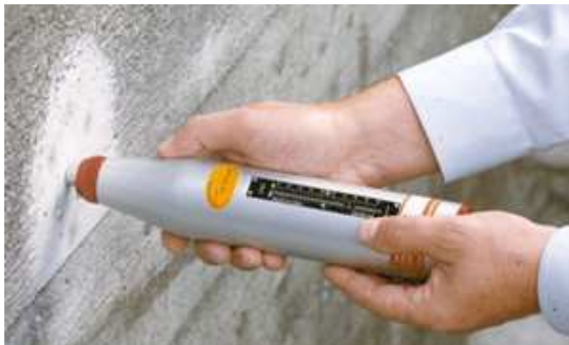
Obr. Použitie Schmidtovho tvrdomera na vybrúsenom mieste
