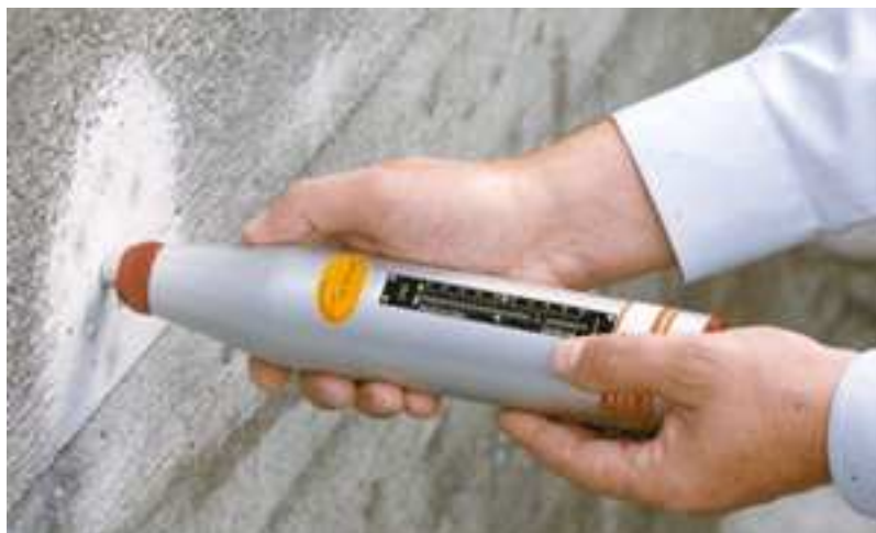
Obr. Použitie Schmidtovho tvrdomera na vybrúsenom mieste
