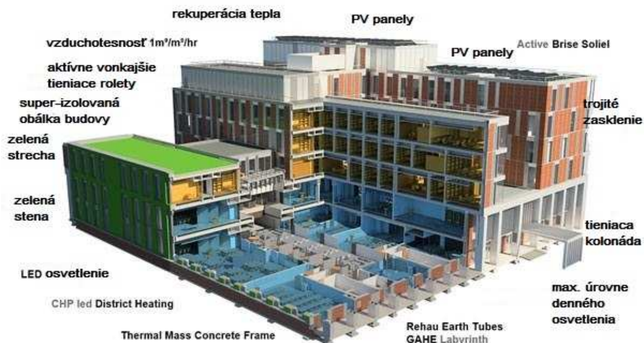
Obr. 33 Kľúčové rysy pasívneho dizajnu budovy The Centre for Medicine
