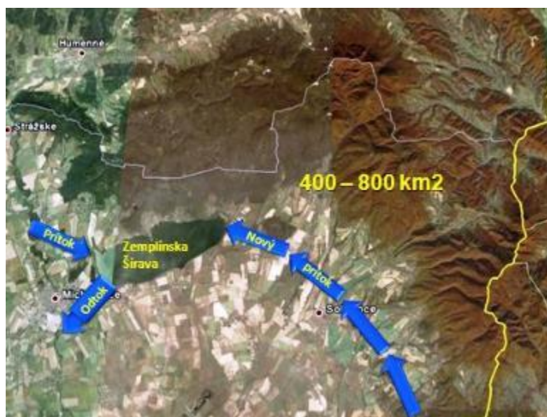
Obr.3: Schéma riešenia vodného zdroja pre Zemplínsku Šíravu
